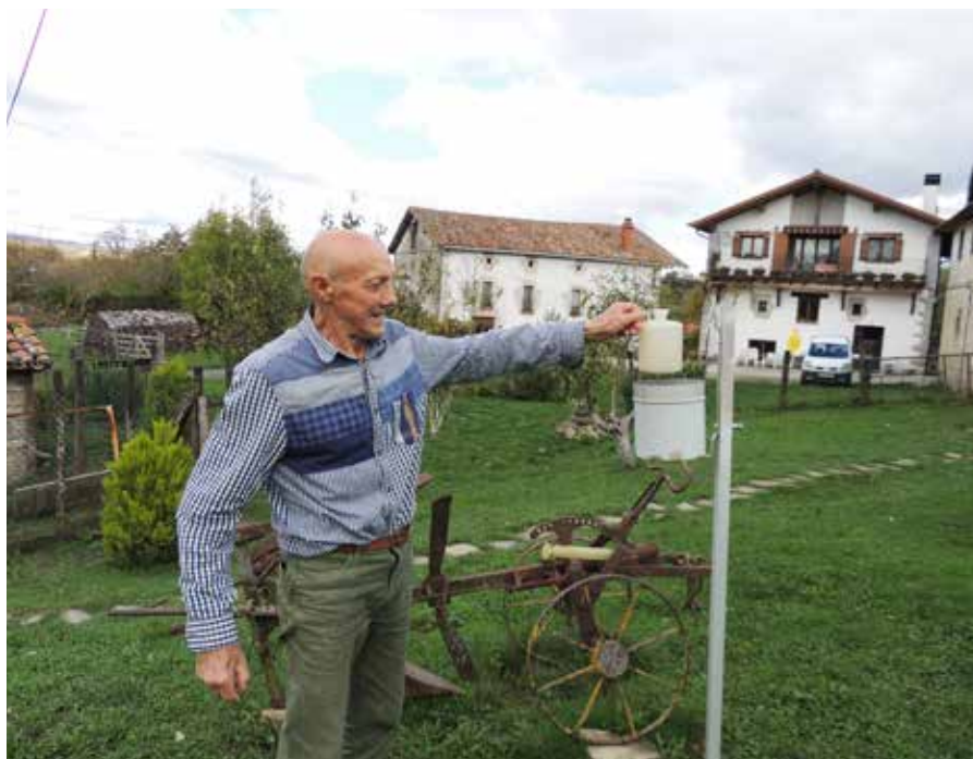
▲ Metalezko zilindro bat bezalakoa da, ura hortik plastikozko ontzi batera doa. Ondoren ontzi horretako ura probeta moduko batera bota eta hor ikusi ditzakezu mililitroak.
